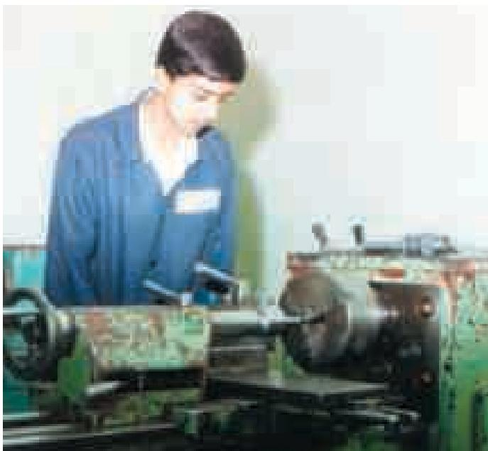
شکل ۶-۴— نمونه ای از شرايط نایمن — ماشین تراش حفاظ شفاف بر روی منطقه کاری ندارد و فرد از عینک حفاظتی استفاده نکرده است.
