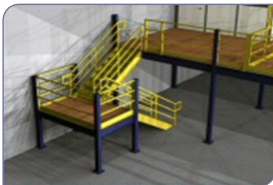
شکل ۲۵-۵. ایجاد پله U شکل
