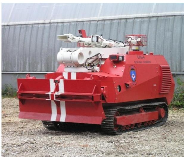
نمونه هایی از روبوت های اطفاء حریق روسی
